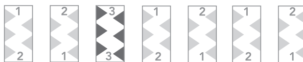
Pour denture impaire, ne montez qu'une fois la plaquette no. 3
